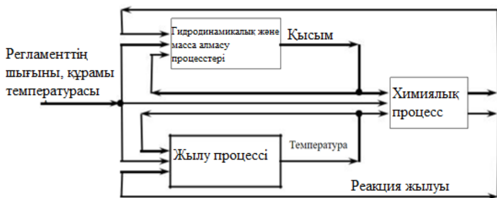
1.5 -сурет - Химиялық реактордың құрылымдық схемасы
